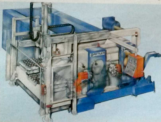
Die Pittler CNC-Maschine Petra ist ein flexibles Bearbeitungssystem mit Portalroboter und Palettenspeicher. Die Steuerung bietet Anschlüsse für PCs.
